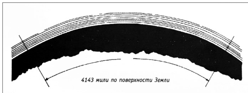
Ил. 6. Чертеж сегмента Земли и ее атмосферной оболочки. Очевидно, что электромагнитные излучения не смогут пройти сквозь такой тонкий слой между двумя токопроводящими поверхностями на какое-либо значительное расстояние, не будучи поглощенными, как считает доктор Тесла, рассматривая волновую теорию эфирного пространства
