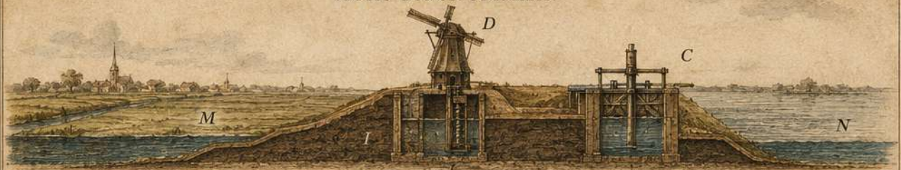
FIG. II. NOVA MOLENDI MACHINA. SCHEPRAD MET VIJZEL.
